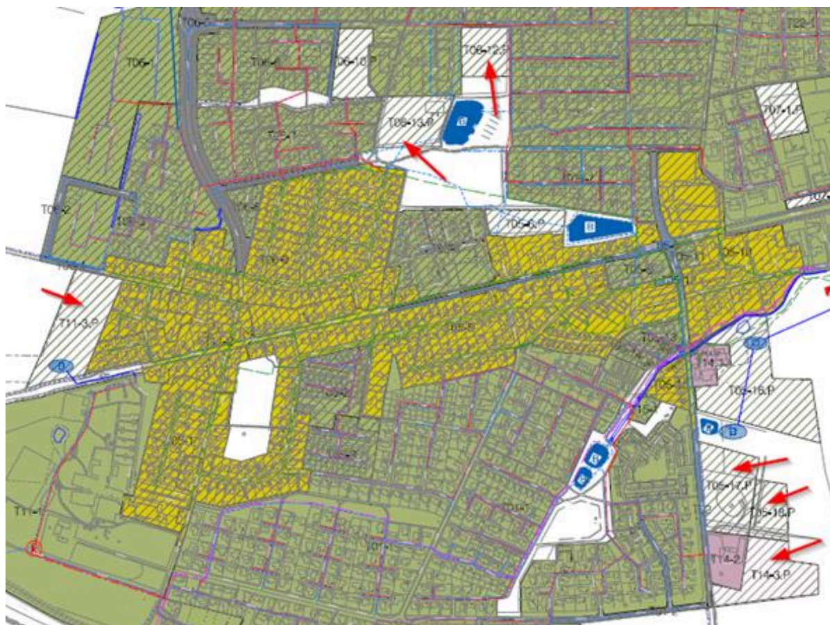
Kort 1. Med røde pile er angivet seks nye oplande, som med dette tillæg indføres i spildevandsplanen for Snebjerg. Områderne er til boliger og offentlige formål.
