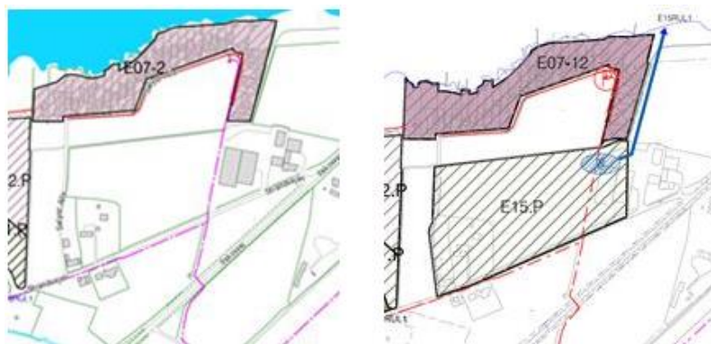
Figur 6. Nuværende spildevandsplan til venstre og kommende spildevandsplan med nyt opland E15.P til højre.
