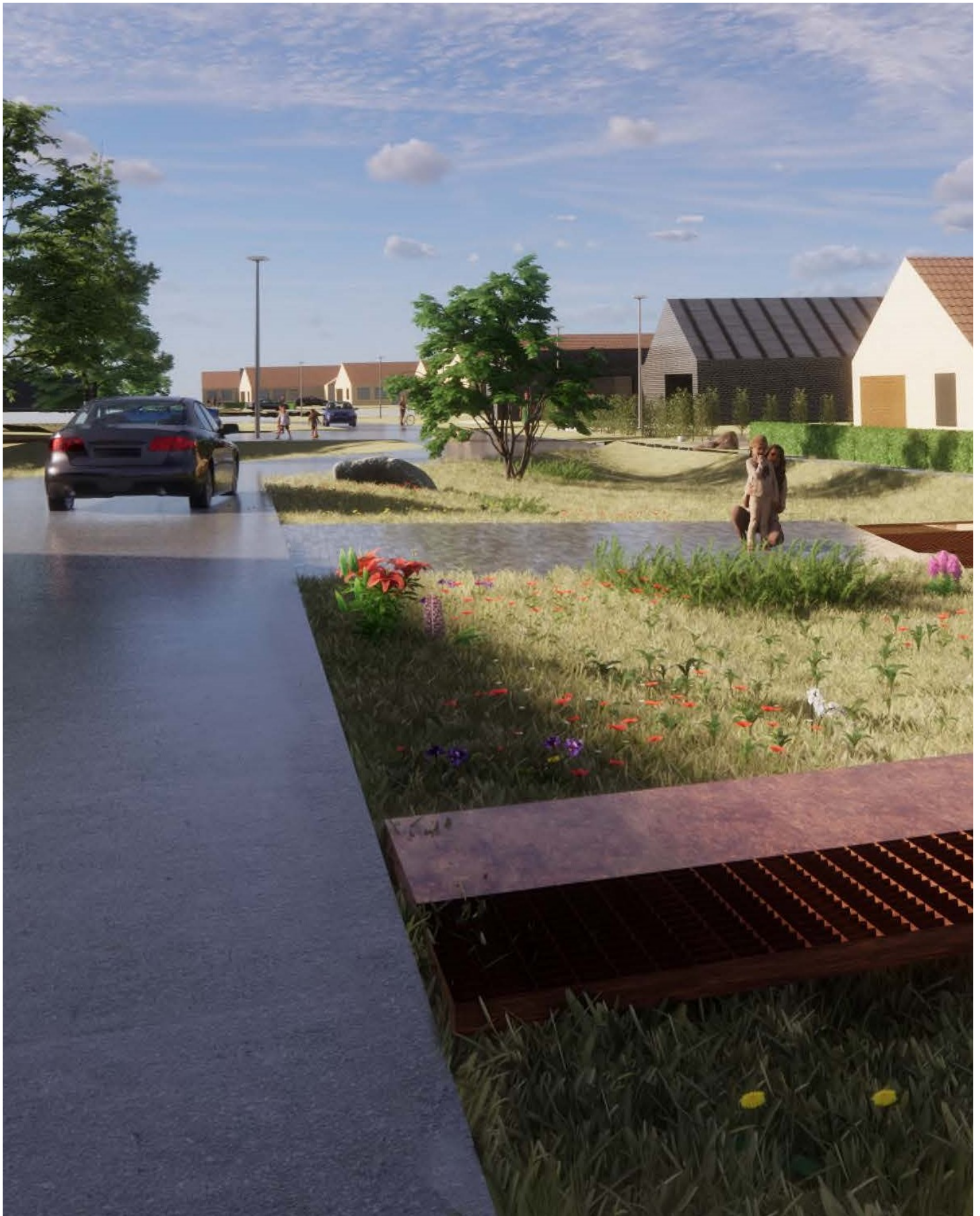
Eksempel på regnvandsbed
